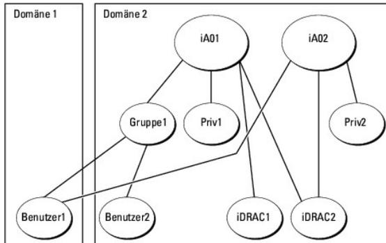
Die Abbildung zeigt zwei Zuordnungsobjekte - iA01 und iA02. Benutzer1 ist über beide Verbindungsobjekte mit iDRAC2 verbunden. Benutzer1 verfügt daher über die Berechtigungen, die sich aus der Kombination der Berechtigungen für die Objekte Priv1 und Priv2 auf iDRAC2 ergeben.
