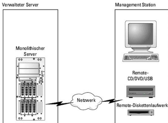
Mit dem **virtuellen Datenträger** können Administratoren im Remote-Zugriff verwaltete Server starten, Anwendungen installieren, Treiber aktualisieren oder sogar neue Betriebssysteme von virtuellen CD/DVD- und Floppy-Laufwerken installieren.
